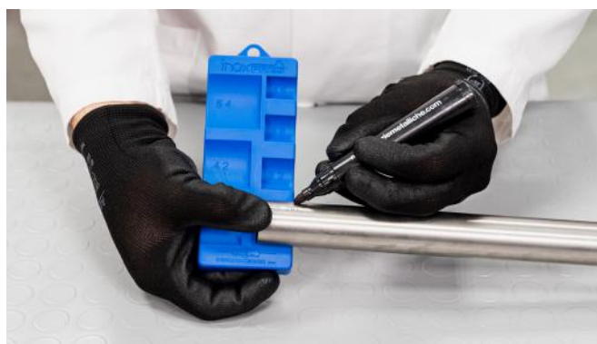
Figura 28 - Marcatura della profondità d'innesto
