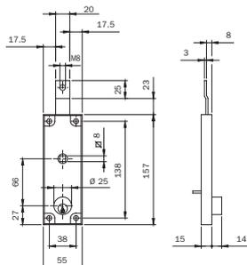
Serratura per serranda. Applicazione verticale. Scatola verniciata. CATENACCIO zincato con FORO FILETTATO M8 PER AGGANCIAMENTO ASTA. 1 mandata da mm 25 con maniglia, QUADRO MANIGLIA mm 8, sbloccaggio maniglia con cilindro tondo Ø mm 25 dall'esterno e con levetta dall'interno. Cilindro sporgente dalla scatola serratura di mm 14. 2 CHIAVI A PROFILO STANDARD (chiave grezza codice 020259).
