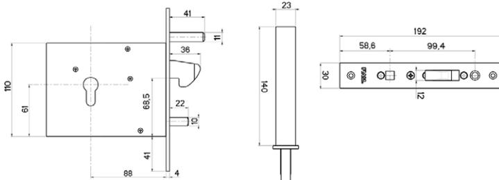
Elettroserratura da infilare 381 EGI.
