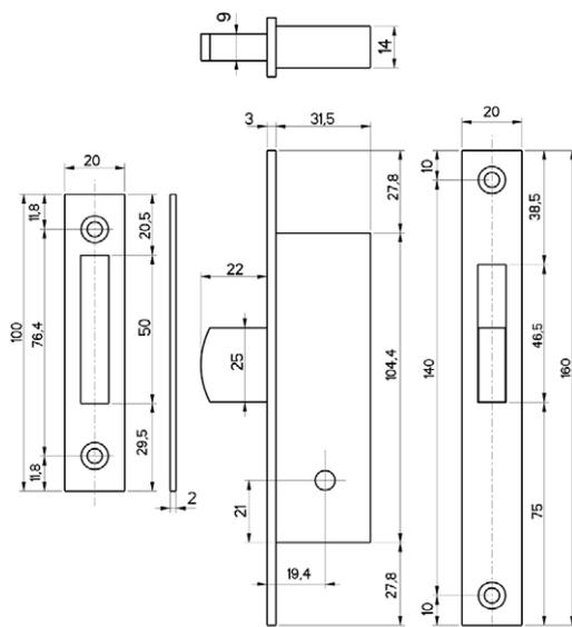
Serratura da infilare per montanti. Interasse 20.
