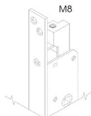
Serratura da infilare per **PERSIANE**, CHIUSURA TRIPLICE, con CILINDRO A SPILLO MONTATO (inserto 990875). Raccordo per aggancio aste M8 premontato. Escursione aste mm 15. Frontale mm **290x24x3** in ACCIAIO ZINCATO. CATENACCIO rotante mandata da mm 24. Mandata con maniglia quadro mm 8, bloccaggio maniglia con cilindro. 3 CHIAVI. 2 boccole guidachiave. (Chiave grezza codice 020275)
