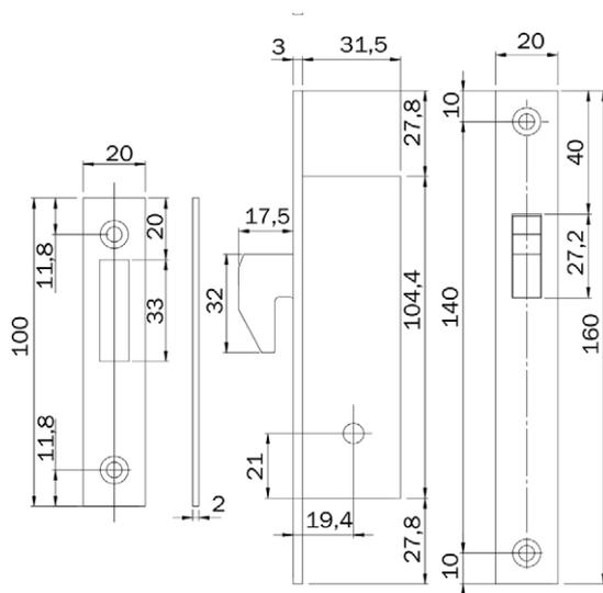
Serratura da infilare per montanti. Interasse 20.
