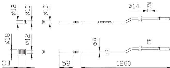
Coppia aste deviate interne. Tubo zincato Ø mm 8 con asola per innesto a vite M4. 2 puntali Ø mm 8. Incontro per puntale in nylon Ø mm 8. 2 boccole antirumore per aste in nylon. 1 raccordo aste. 2 guida aste in nylon. 1 boccola antipolvere a pavimento foro Ø mm 12. Per serrature con aggancio aste a vite serie 7820-783\*-963\*
