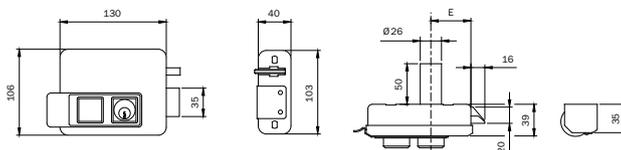
Elettroserratura da applicare **DESTRA VERNICIATA. 12Vac 15W**. Pulsante interno, cilindro interno per **“BLOCCO PULSANTE”** o per funzione **“FERMO A GIORNO”** cilindro fisso Ø mm 26x50 esterno. Scrocco autobloccante. Pistone di carica separato forza regolabile. 3 CHIAVI. Bocchetta (Chiave grezza codice 020259) regolabile. Ghiera. Foglio istruzioni. **Confezione con tettuccio porta serratura e piastra per bocchetta.** (chiave grezza cod. 020259)
