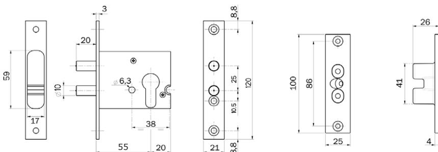
Serratura da infilare con cilindro a profilo europeo.
