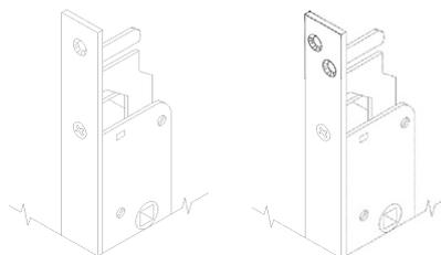
Serratura da infilare per montanti, CHIUSURA TRIPLICE, cilindro a profilo europeo.
