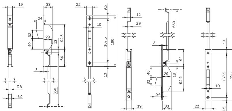
Deviatori per CHIUSURA TRIPLICE, laterale. Aste interne da abbinare alle serrature con aggancio aste a vite.
