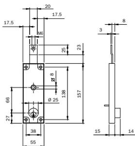
Serratura per serranda. Applicazione **VERTICALE**. Scatola verniciata. CATENACCIO zincato con FORO FILETTATO M6 PER AGGANCIAMENTO ASTA. 1 mandata da mm 25 con maniglia, QUADRO MANIGLIA mm 8, sbloccaggio maniglia con cilindro tondo Ø mm 25 dall'esterno e con levetta dall'interno. Cilindro sporgente dalla scatola serratura di mm 14. 2 CHIAVI A PROFILO STANDARD (chiave grezza codice 020259).
