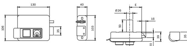
Elettroserratura da applicare **DESTRA VERNICIATA. 12Vac 15W**. Cilindro interno e cilindro fisso  $\varnothing$  mm 26x50 esterno.
