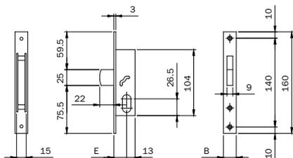
Serratura da infilare per montanti a scatola aperta, cilindro ovale.
