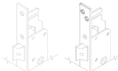
Serratura da infilare per montanti, CHIUSURA TRIPLICE, cilindro a profilo europeo.
