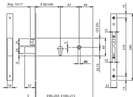
Serratura da infilare a cilindro profilo europeo per fascia. **MODULARE. CHIUSURA LATERALE.** Frontale INOX **240x22x3**. Altezza cassa mm 64. Tre mandate da mm 12. **SCROCCO SEPARATO REVERSIBILE E REGOLABILE.** POSSIBILITÀ DI SOSTITUIRE LO SCROCCO CON IL RULLO O CON IL TAPPO PER CHIUSURA SOLO CATENACCIO. 2 ghiera. Coppia spessori sottofrontale. Grano interno per fissaggio cilindro. Viti fissaggio. Foglio istruzioni.
