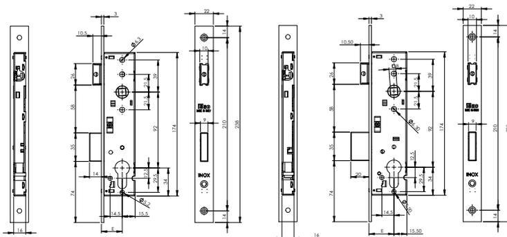
Serratura da infilare per montanti con cassa chiusa funzionante con cilindro europeo.
