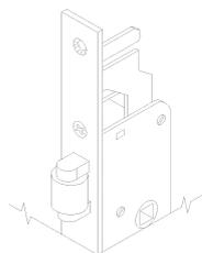
Serratura da infilare per montanti, CHIUSURA TRIPLICE, cilindro a profilo europeo.
