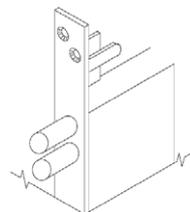
Serratura da infilare doppia mappa per fascia. CHIUSURA TRIPLICE. Aggancio aste ad innesto. 3 CHIAVI da mm 79. Frontale acciaio zincato **240x24x3**. Altezza cassa mm 64. Quattro mandate, due pistoni Ø 13, da mm 9. **SCROCCO SEPARATO REVERSIBILE**. Richiamo scrocco con chiave o QUADRO MANIGLIA mm 8. 2 ghiera. Viti fissaggio. (Chiave grezza codice 990800).
