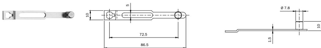
Coppia piastrine con perno, per collegamento tra serratura o deviatori con agganci a vite M4 e aste esterne. In acciaio zincato.
