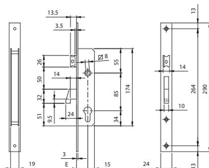
Serratura da infilare per montanti, CHIUSURA LATERALE, cilindro a profilo europeo.
