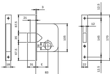
Serratura per cancello. Scatola e frontale zincati tropicalizzato. Funzionante con cilindro Ø mm 26 sfaccettato.
