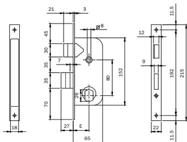
Serratura per cancello. Scatola e frontale zincati tropicalizzato. Funzionante con cilindro Ø mm 26 sfaccettato.
