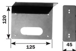
Piastra porta elettroserratura ambidestra per serratura serie 510\*-52\*\*-53\*\*.
