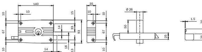
Serratura da applicare ZINCATA senza aletta per ferro, **DESTRA**. 4 fori di fissaggio. Cilindro interno e cilindro fisso Ø mm 26x50 esterno, scrocco reversibile separato con TIRANTE INTERNO e richiamo con chiave esterno. CATENACCIO a 3 mandate. 3 CHIAVI. Bocchetta. (Chiave grezza codice 020259)
