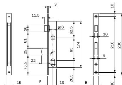
Serratura da infilare per montanti a scatola aperta, cilindro ovale.
