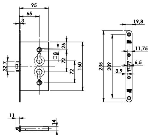
Serratura multiuso da infilare. Chiusura **LATERALE**.
