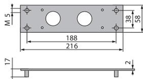
Piastra di fissaggio in acciaio.
