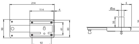
Serratura da applicare per ferro con pomolo sblocca CATENACCIO interno e cilindro fisso
