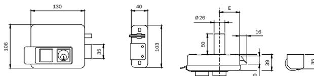
Elettroserratura da applicare **DESTRA VERNICIATA. 12Vac 15W**. Cilindro interno e cilindro fisso D 26x50 esterno. Scrocco autobloccante. Pistone di carica separato forza regolabile. 3 CHIAVI. Bocchetta regolabile. Ghiera. Foglio istruzioni. **Confezione con tettuccio porta serratura e piastra per bocchetta.** (Chiave grezza codice 020259)
