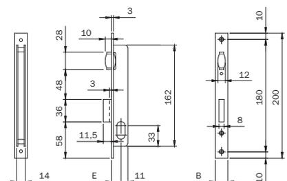
Serratura da infilare per montanti a scatola aperta, cilindro ovale. 1 mandata da 9 mm
