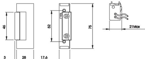
Incontro elettrico senza frontale, **L'APERTURA AVVIENE SOLO IN CASO DI INTERRUZIONE DI CORRENTE** (Fail safe). Senza leva fermo a giorno.
