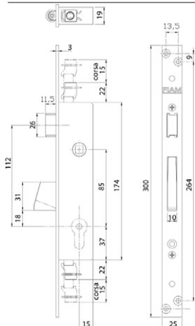
Serratura da infilare per montanti, cilindro a **spillo**.
