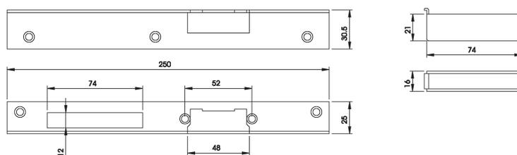
Contropiastra chiusa angolare **DESTRA**, in acciaio **VERNICIATO ORO** mm **250x30,5x25**, per serrature da infilare per serramenti in legno serie 200-205-210-215-221-240-250-741-291. Abbinabile a incontri elettrici serie 0400\*0 e 0401\*0. Con vaschetta nylon.
