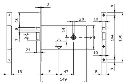
Elettroserratura ZINCATA da infilare per fascia a cilindro ovale. **12Vac**.
