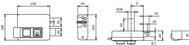
Elettroserratura da applicare **DESTRA VERNICIATA. 12Vac 15W**. Pulsante intero. 2 mandate azionabili con cilindro interno e cilindro fisso Ø mm 26x50 esterno. Scrocco autobloccante con pistone di carica incorporato forza regolabile. 3 CHIAVI. Bocchetta regolabile. Ghiera. Foglio istruzioni. (Chiave grezza codice 020259)
