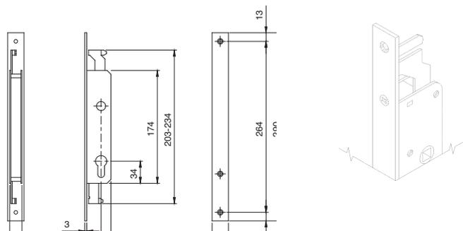
Serratura da infilare per montanti, CHIUSURA DUPLICE **ALTO/BASSO**, cilindro a profilo europeo.
