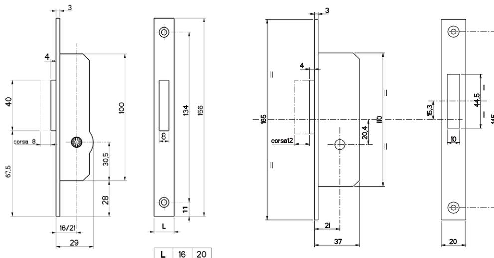
Serratura da infilare per montanti.
