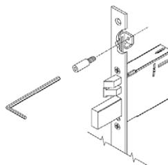
Elettroserratura da infilare doppia mappa per fascia. **12Vac/dc**. CHIUSURA TRIPLICE. Agganci aste a vite.
