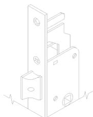
Serratura da infilare per montanti, CHIUSURA TRIPLICE, cilindro a profilo europeo.
