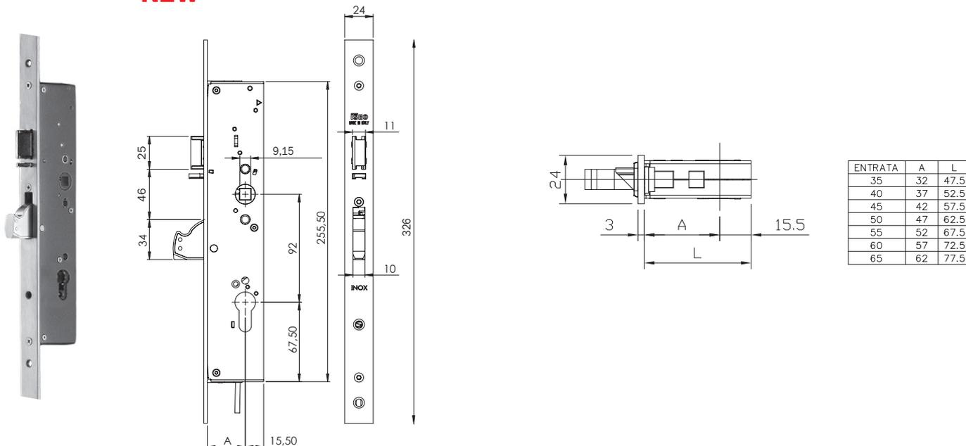
Multiblindo Easy EXIT con funzione antipanico è costituita da serratura LATERALE da infilare per montanti con relative contropiastre e la barra di azionamento Pro EXIT. Serratura centrale, interasse mm 92, quadro maniglia 9, cilindro a profilo europeo.
