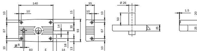
Serratura da applicare per ferro senza aletta, ZINCATA, con cilindro interno e cilindro fisso Ø mm 26x50 esterno, scrocco separato, QUADRO MANIGLIA mm 8. CATENACCIO a 3 mandate. Entrata mm 60. 3 CHIAVI. Bocchetta. Ghiera. (Chiave grezza codice 020259)
