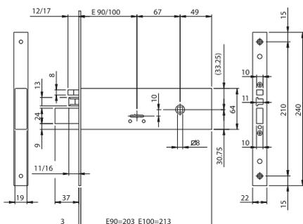
Elettroserratura da infilare doppia mappa per fascia. **12Vac/dc**. CHIUSURA LATERALE. 3 CHIAVI da **mm 100**.
