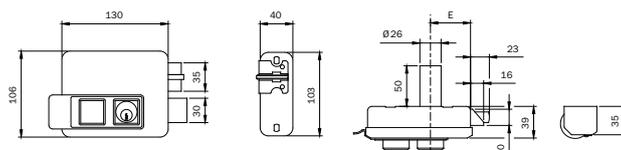
Elettroserratura da applicare **DESTRA VERNICIATA. 12Vac 15W**. Cilindro interno e cilindro fisso Ø mm 26x50 esterno. 2 mandate. Scrocco autobloccante con pistone di carica incorporato forza regolabile. 3 CHIAVI. Bocchetta regolabile. Ghiera. Foglio istruzioni. **Confezione con tettuccio porta serratura e piastra per bocchetta.** (Chiave grezza codice 020259)
