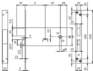
Serratura da infilare doppia mappa per fascia. CHIUSURA LATERALE. 2 CHIAVI da **mm 79**. Entrata 90 mm Frontale acciaio zincato **240x25x3**. Altezza cassa mm 82. Quattro mandate da mm 9.
