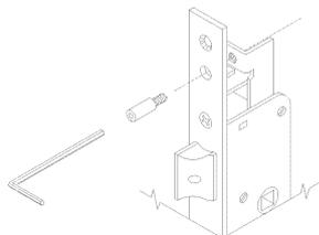
Serratura da infilare per montanti, CHIUSURA TRIPLICE, cilindro a profilo europeo. Aggancio aste a vite.
