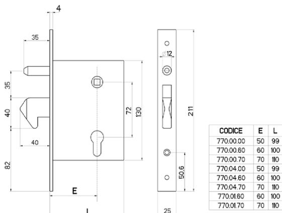
Serratura da infilare con cilindro a profilo europeo.
