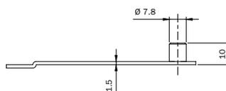
Coppia piastrine con perno, per collegamento tra serratura o deviatori con agganci a vite M4 e aste esterne. In acciaio zincato.
