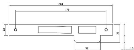
Contropiastre per serratura da fascia e montante in acciaio INOX **204x22x1,5** per serie 77 - 78
