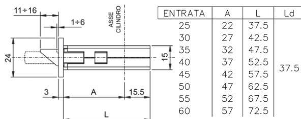
Serratura MULTIPUNTO da infilare per montanti, CHIUSURA TRIPLICE,
