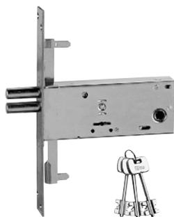
Serratura da infilare doppia mappa per fascia. CHIUSURA TRIPLICE. Aggancio aste ad innesto. 3 CHIAVI da mm 79. Frontale acciaio zincato **240x24x3**. Altezza cassa mm 64. Quattro mandate, due pistoni Ø mm 13, da mm 9. 2 ghiera. Viti fissaggio. (Chiave grezza codice 990800).
