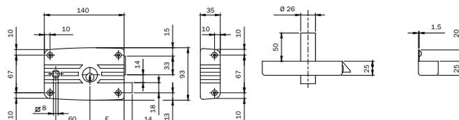
Serratura da applicare per ferro senza aletta, VERNICIATA NERA, con cilindro interno e cilindro fisso
