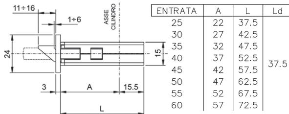
Serratura MULTIPUNTO da infilare per montanti, CHIUSURA TRIPLICE,
