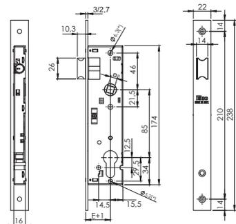
Serratura da infilare per montanti con cassa chiusa funzionante con cilindro europeo.
