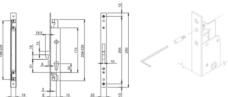
Serratura da infilare per montanti, CHIUSURA TRIPLICE, cilindro a profilo europeo.
