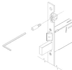
Serratura da infilare doppia mappa per fascia. **MODULARE**. CHIUSURA TRIPLICE. Agganci aste a vite.
