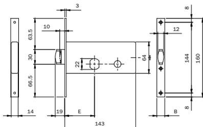
Serratura per fascia. CHIUSURA LATERALE. Funzionante con **CILINDRO TONDO SFACCETTATO Ø MM 22** (840027277) in dotazione.
