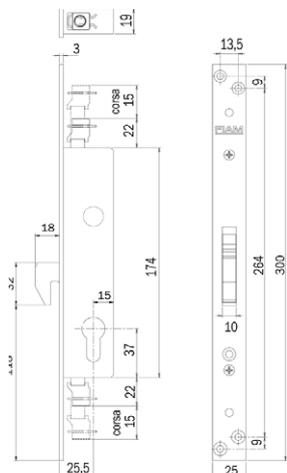
Serratura da infilare per montanti, **cilindro a profilo europeo**.
