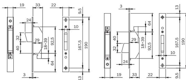
Deviatori per CHIUSURA TRIPLICE, laterale. Per montaggio con aste esterne, da abbinare con serrature con
