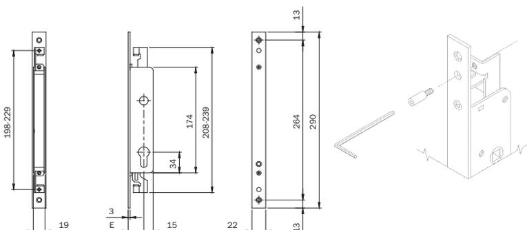
Serratura da infilare per montanti, CHIUSURA DUPLICE **ALTO/BASSO**, cilindro a profilo europeo.
