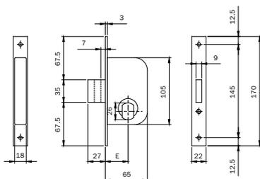
Serratura per cancello. Scatola e frontale zincati tropicalizzato. Funzionante con cilindro Ø mm 26 sfaccettato.
