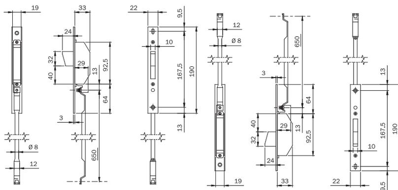
Deviatori per CHIUSURA TRIPLICE, LATERALE. Aste interne da abbinare alle serrature con **AGGANCIAMENTO A VITE**.
