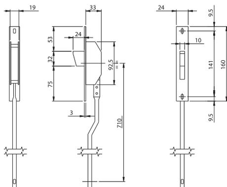
Deviatori per CHIUSURA TRIPLICE, LATERALE. Aste interne collegate da abbinare alle serrature con **AGGANCIO ASTE AD INNESTO**.
