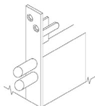
Serratura da infilare doppia mappa per fascia. CHIUSURA LATERALE. 3 CHIAVI da mm 79. Entrata 90 mm Frontale acciaio zincato **240x25x3**. Altezza cassa mm 82. Quattro mandate da mm 9. **SCROCCO SEPARATO REVERSIBILE**. Richiamo scrocco con chiave o QUADRO MANIGLIA mm 8. 2 ghiera. Viti fissaggio. **CONFEZIONE SCATOLA SINGOLA**. (Chiave grezza codice 990800).
