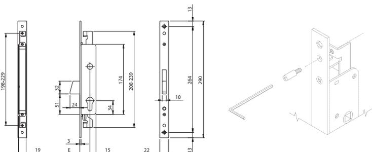
Serratura da infilare per montanti, CHIUSURA TRIPLICE, cilindro a profilo europeo.
