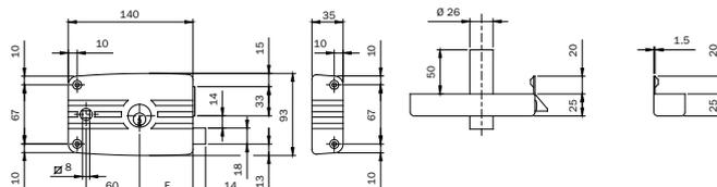
Serratura da applicare per ferro con aletta, ZINCATA, con cilindro interno e cilindro fisso
