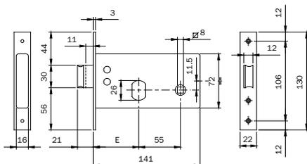
Serratura per fascia. CHIUSURA LATERALE. Funzionante con **CILINDRO TONDO SFACCETTATO Ø MM 26** (842028287) in dotazione. 3 CHIAVI. Scatola H 72 ZINCATA. Frontale mm **130x22x3** zincato.
