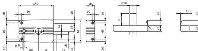
Serratura da applicare per ferro con aletta, VERNICIATA NERA, con cilindro interno e cilindro fisso
