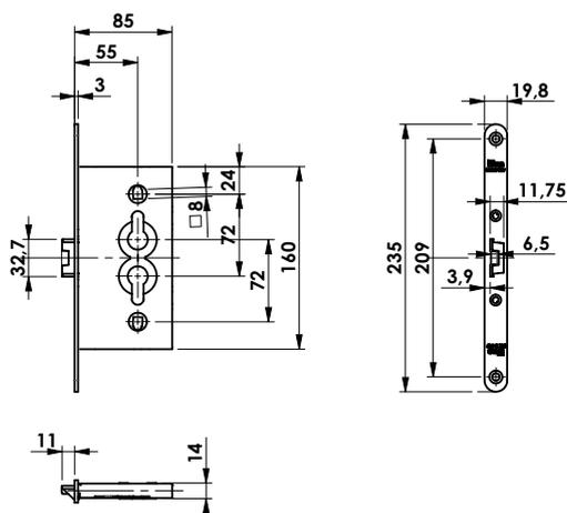
Serratura multiuso da infilare. Chiusura **LATERALE**.
