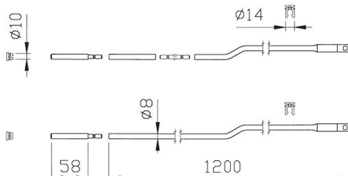
Coppia aste deviate interne. Tubo zincato Ø mm 8 con asola per innesto a vite M4. 2 puntali Ø mm 8. Incontro per puntale in nylon Ø mm 8. 2 boccole antirumore per aste in nylon. 1 raccordo aste. 2 guida aste in nylon. 1 boccola antipolvere a pavimento foro Ø mm 12.
