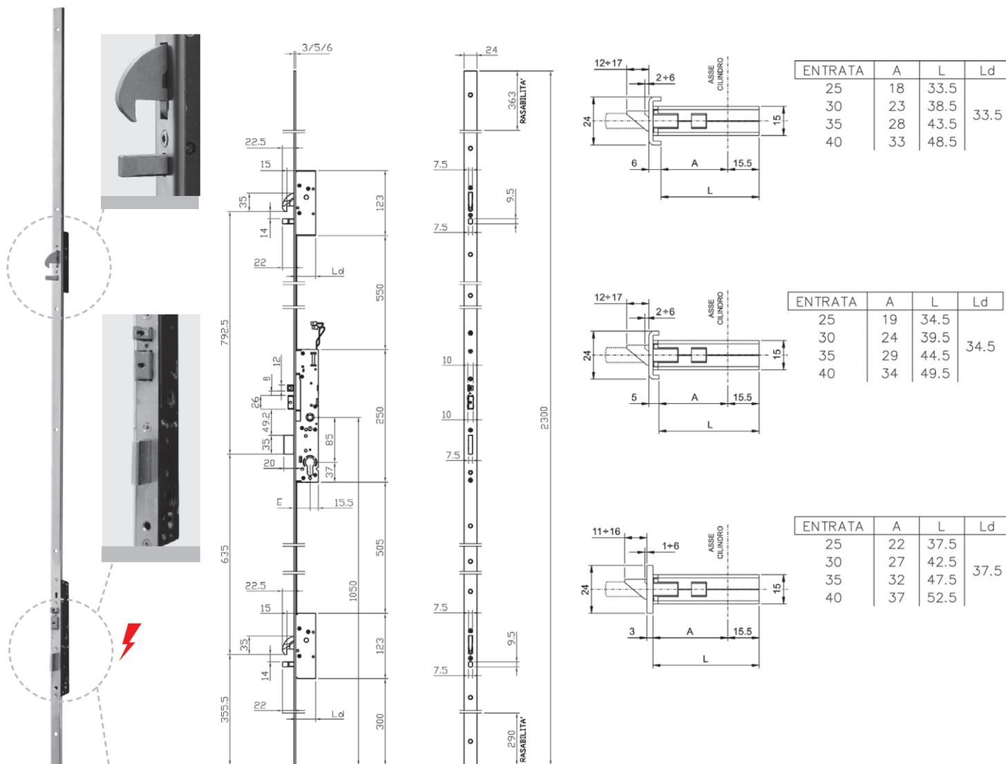
Elettroserratura MULTIPUNTO da infilare per montanti, CHIUSURA TRIPLICE,
