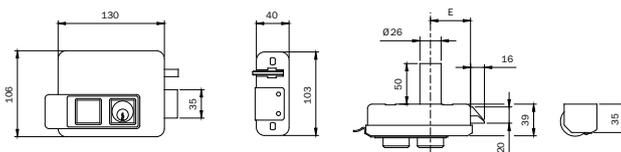
Elettroserratura da applicare **DESTRA VERNICIATA. 12Vac 15W**. Pulsante interno e cilindro fisso  $\varnothing$  mm 26x50 esterno.
