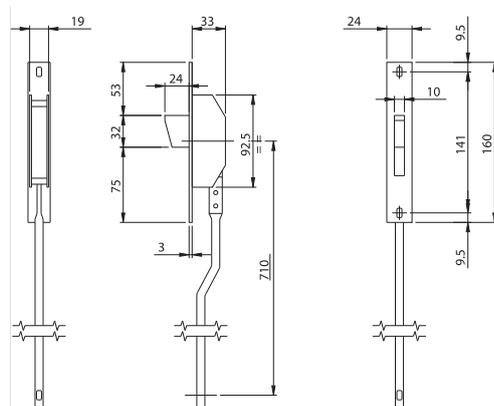
Deviatori per CHIUSURA TRIPLICE, laterale. Aste interne collegate da abbinare alle serrature
