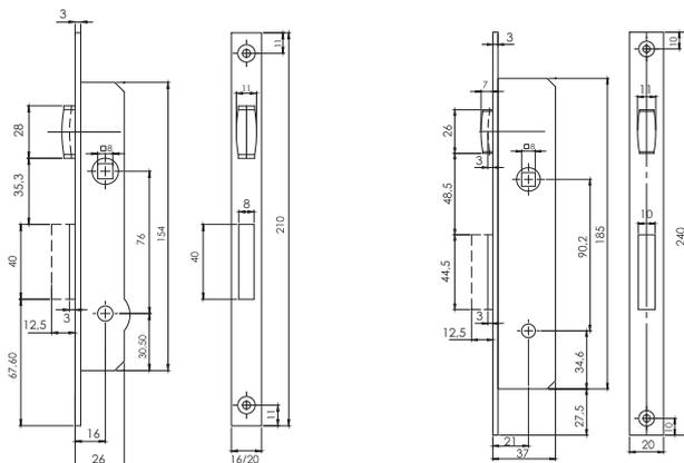
Serratura da infilare per montanti.
