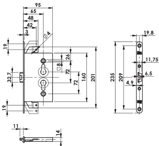
Serratura multiuso da infilare. Chiusura **TRIPLICE**.
