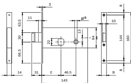
Serratura per fascia. CHIUSURA LATERALE. Funzionante con **CILINDRO TONDO SFACCETTATO Ø MM 22**
