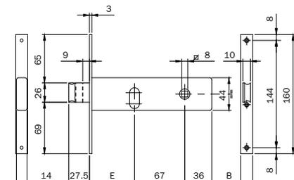
Serratura per fascia. CHIUSURA LATERALE. Funzionante con cilindro ovale. Scatola H 44 ZINCATA.
