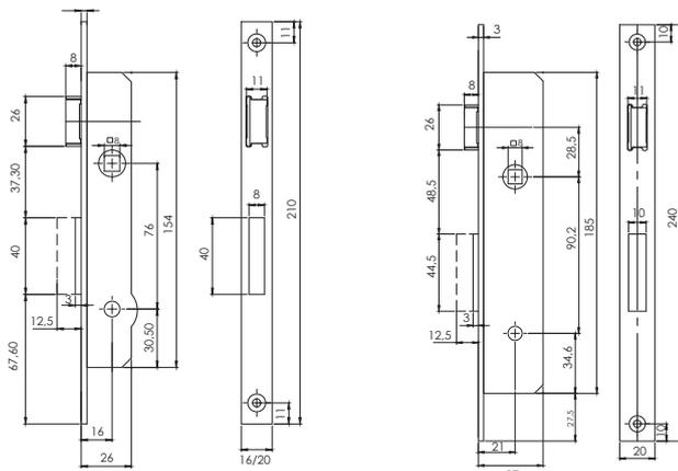
Serratura da infilare per montanti.
