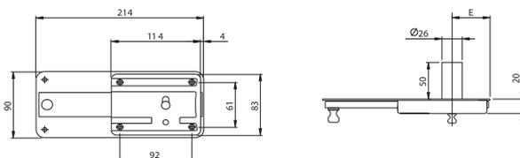
Serratura da applicare per ferro con pomolo sblocca CATENACCIO interno e cilindro fisso
