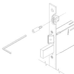
Serratura da infilare a cilindro profilo europeo per fascia. **MODULARE. CHIUSURA TRIPLICE.** Agganci aste a vite. Frontale INOX **240x22x3**. Altezza cassa mm 64. Tre mandate da mm 12.
