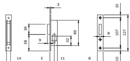
Serratura da infilare per montanti a scatola aperta, cilindro ovale. 1 mandata da 9 mm
