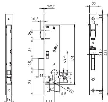
Serratura da infilare per montanti con cassa chiusa funzionante con cilindro profilo europeo.
