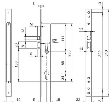
Elettroserratura da infilare per montanti, CHIUSURA LATERALE, **12Vac/dc**, cilindro a profilo europeo.
