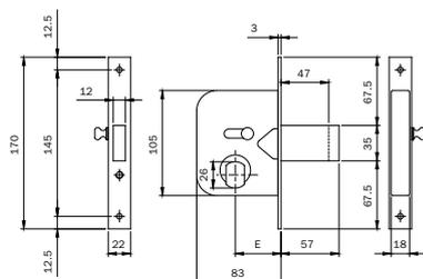
Serratura per cancello. Scatola e frontale zincati tropicalizzato. Funzionante con cilindro Ø mm 26 sfaccettato. CATENACCIO PROLUNGATO E SCROCCO INCORPORATO. **1 MANDATA DA mm 10**. Richiamo scrocco con chiave o pomolo interno. Cilindro in dotazione 84202827 con 3 CHIAVI. 2 ghiera in nylon per cilindro (chiave grezza cod. 020259). Entrata mm 45.
