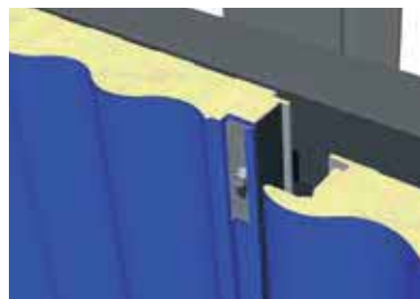
Montaggio dei pannelli in senso verticale
